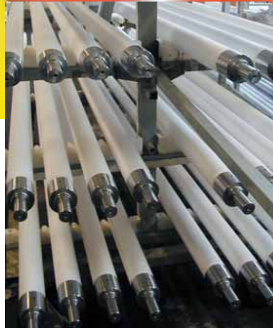
Rollen mit Metallendkappen / rollers with metal end-caps
